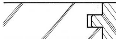
Penutupan sisi tebal dengan lidah dan alur
