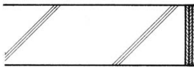
Penutupan sisi tebal dengan finir (3 lapis)
