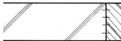
Penutupan sisi tebal dengan lis kayu
